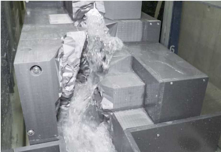
Die Simulation einer Flutwelle wird im massstabsgetreuen Modell der Massaschlucht durchgeführt.
