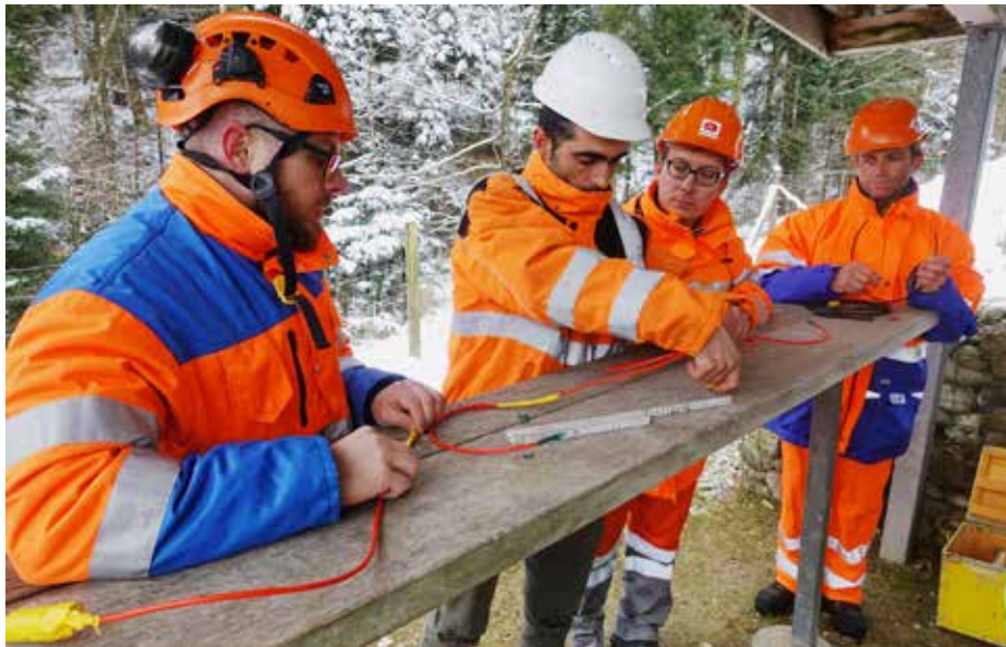
Eine Gruppe von Kursteilnehmern bereitet Sprengschnüre und Sprengkapseln vor.
