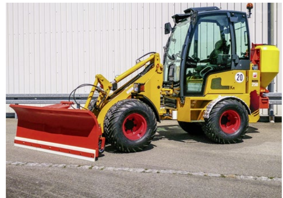
Aus Belgien stammen die KM-Lader (Hesse, Lauingen) wie der KM250 mit Profi-Kabine und Winterdienstausstattung samt Schneeräumer und Heckstreuer, der an einer 3-Punkt-Heckhydraulik montiert ist.
