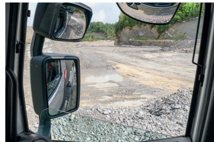
Der Truck verfügt über ein in drei Richtungen verstellbares Lenkrad mit Bedienelementen für Menüsteuerung und Telefon. Daneben liegen die Schalter der Klimaanlage und der automatischen Enteisung für Scheiben und Aussenspiegel (Bilder oben). Die Seitenspiegel (links unten) können elektrisch eingestellt werden. Die Windschutzscheibe (rechts unten) bietet gute Sicht und durch ihre Neigung wenig Ansatzfläche für Verschmutzungen.
