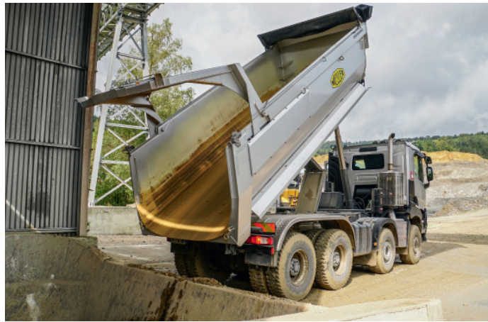
Nach dem Test wird an der Brechanlage des Steinbruchs entladen. Dies verläuft reibungslos durch den geöffneten Rückladen des Kippers.
