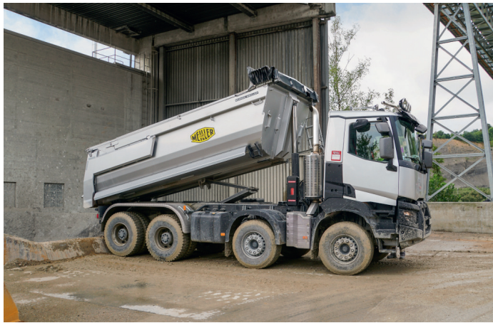
Nach dem Test wird an der Brechanlage des Steinbruchs entladen. Dies verläuft reibungslos durch den geöffneten Rückladen des Kippers.
