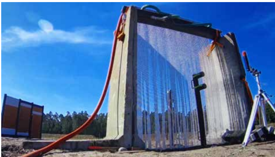
«Kettenhemden» an Gebäuden dienen heutzutage oft als architektonisches Element oder zum Design. Wird das Metallgeflecht zum «Wasservorhang», kann es den Explosionsdruck wirksam reduzieren.
