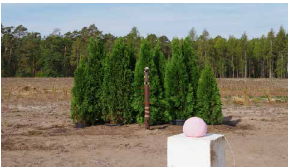
Die rosa Sprengkugel liegt auf einem Styroporblock in der Mitte der drei Pflanzgruppen. Der Plastiksprengstoff wird in einem Abstand von fünf Metern zu den Testpflanzen gezündet.
