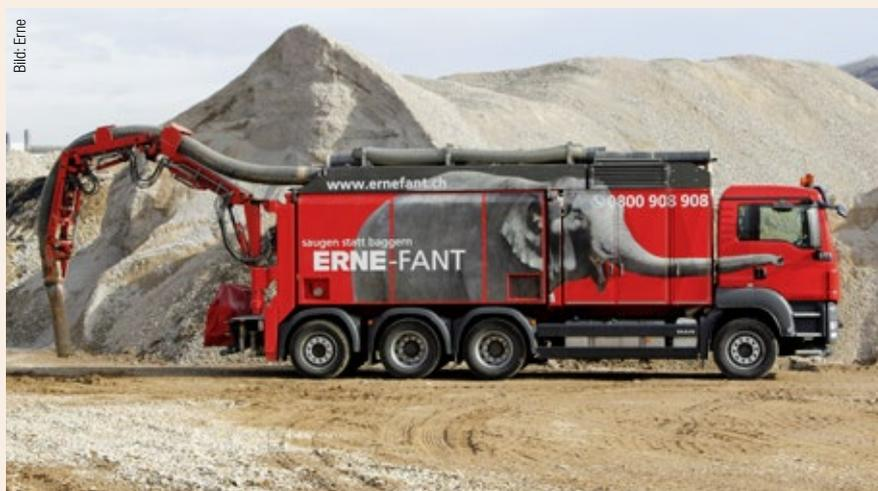
Der Saugbagger «Erne-fant» ist eine mobile, multifunktionale Baumaschine. Bei Bedarf ist er schnell am Einsatzort und innerhalb weniger Minuten einsatzbereit.
