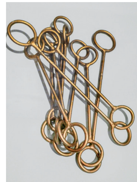
Lachterketten massen die Distanz, die ein Mann mit ausgestreckten Armen umfassen konnte.
