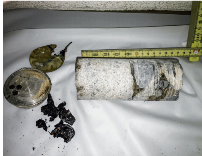
Probenahme im Beton zur radiologischen Klassierung.
