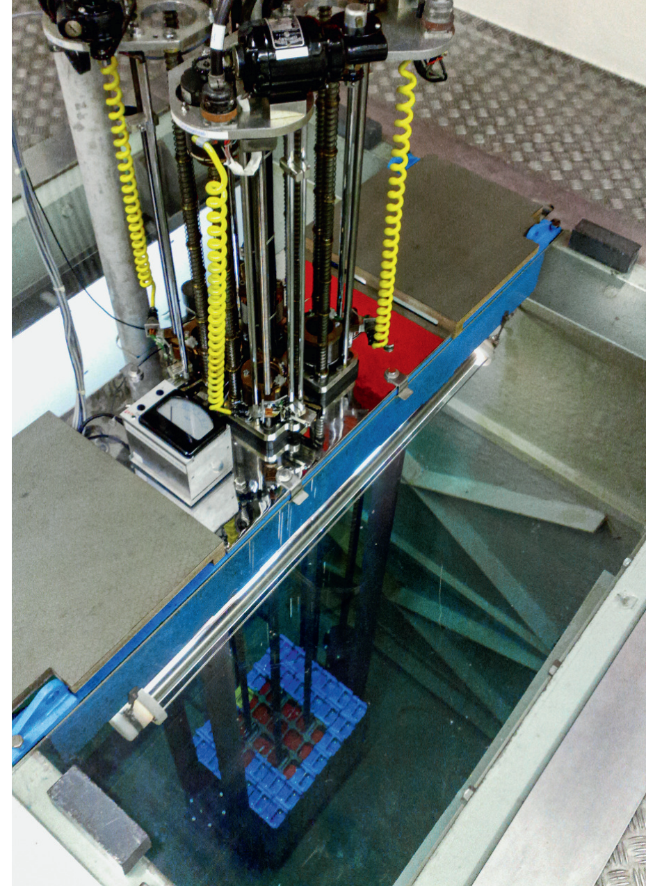
Blick in den Swimmingpool-Reaktor: Die Brennstäbe befanden sich in einem oben offenen Wassertank.
