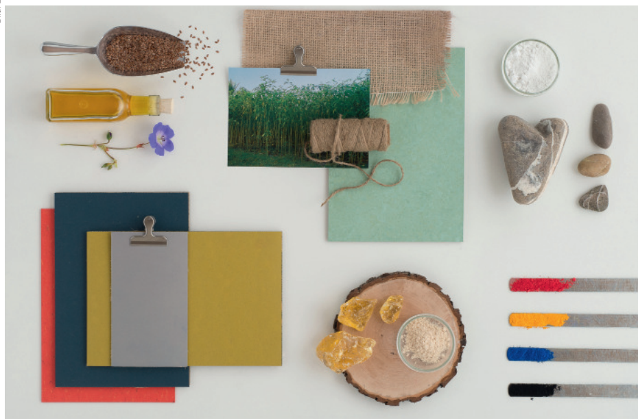
Wie vor über 100 Jahren sind die Ausgangsmaterialien für Linoleum fast unverändert geblieben: Leinöl, Holz- und Kalksteinmehl, Jute, Naturharze, mineralische Füllstoffe und Farbpigmente.
