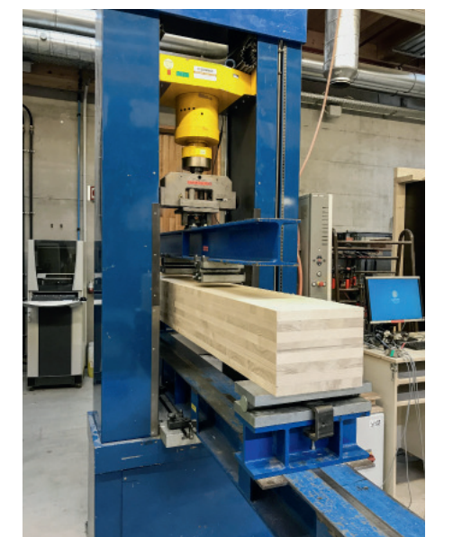
Biegeprüfung der Fuge der angeklebten Balkenplatte anhand eines 20 Zentimeter breiten Streifens.
