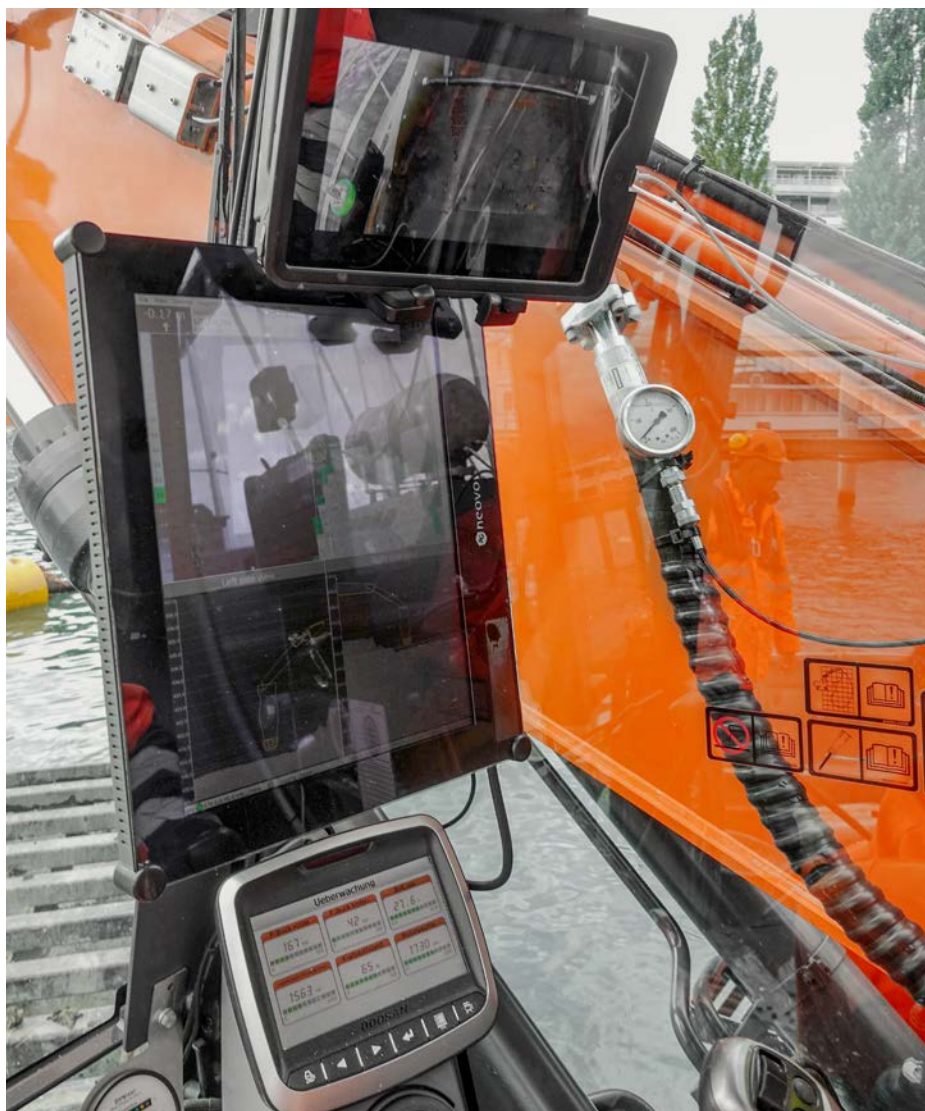
Der Bildschirm des Schwimmbaggers gibt genaue Auskunft, welche Stellen am Seegrund bereits ausreichend gesäubert sind oder wo noch weiter abgesaugt werden muss.
