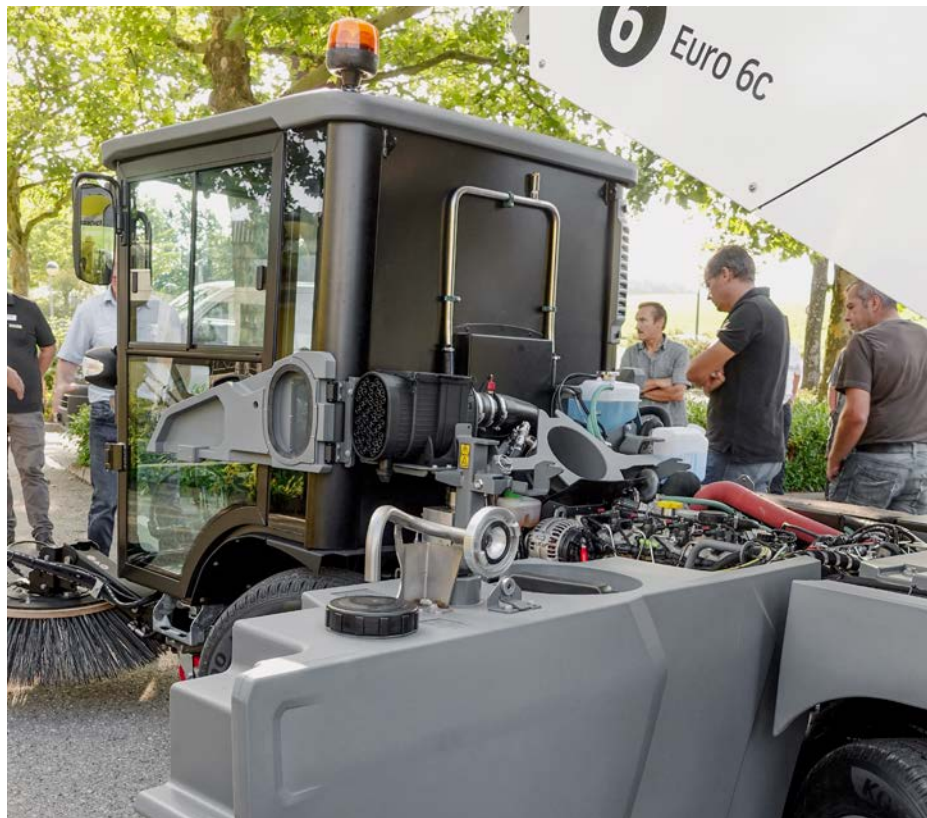
Alle technischen Bauteile sind sicher hinter verschliessbaren Luken eingebaut, die sich leicht zur Wartung oder Reparatur öffnen lassen.
