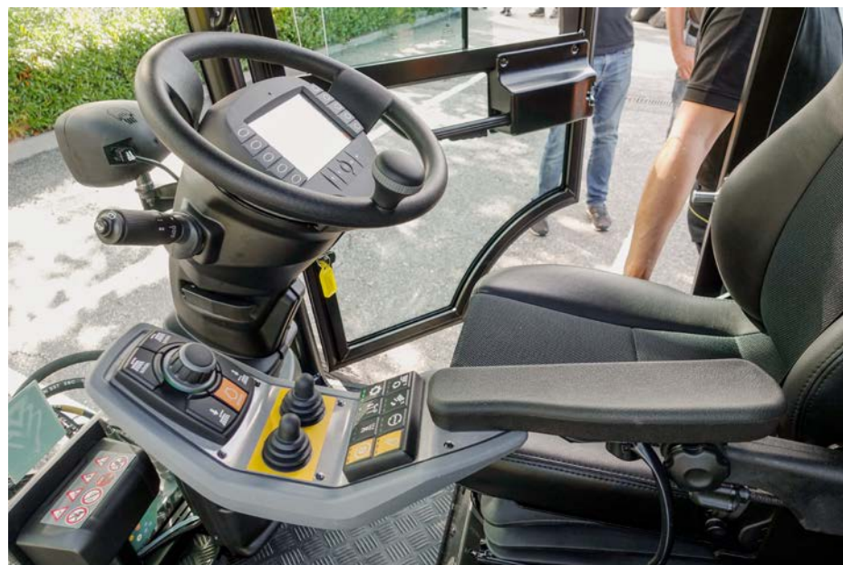
Der gefederte Komfortsitz und übersichtlich angeordnete Bedienelemente erleichtern die Arbeit. Das Display befindet sich im Lenkrad.
