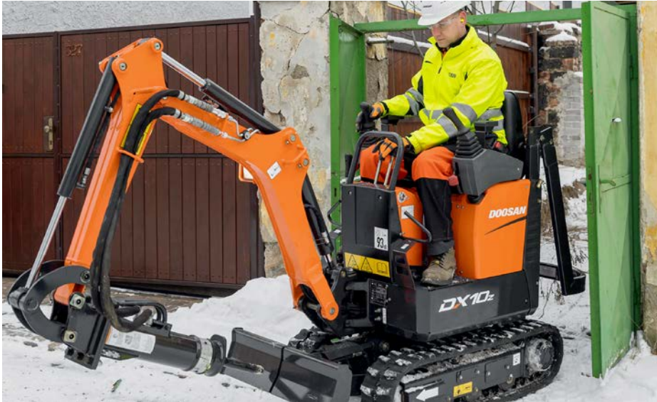
Der Doosan DX10Z bietet Vielseitigkeit durch eine Vielzahl an Anbaugeräten – hier zum Beispiel mit angebautem Hydraulikhammer.
