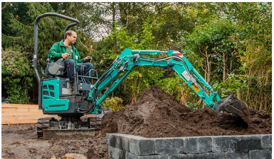
Der kompakte Kobelco SK 10 SR folgt einem allgemeinen Trend zu Kurzheckbaggern mit einem geringen Heckschwenkradius bei Hand angefordert.
