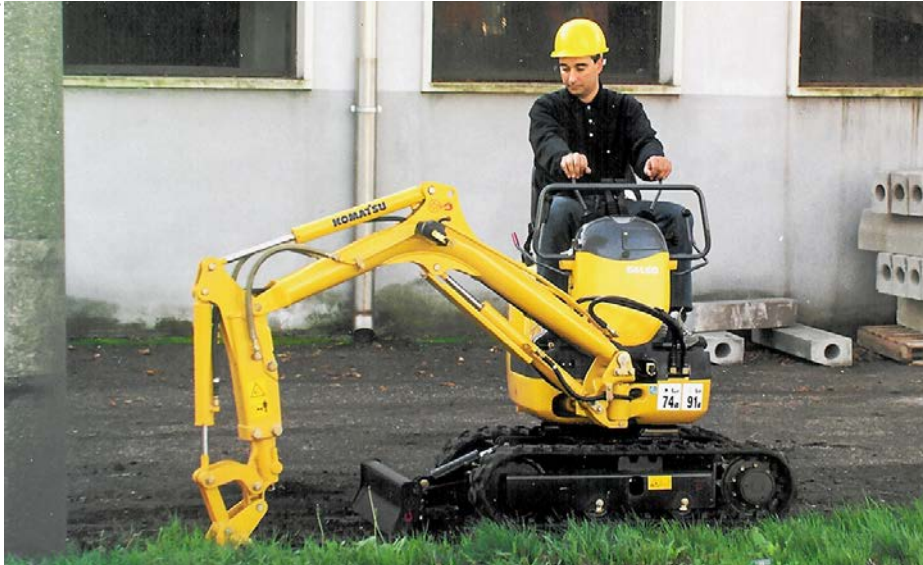
Mit eingeschwenktem Ausleger können Maschinen wie dieser Komatsu PC09-1 auch quer zum Laufwerk Gräben ausheben.
