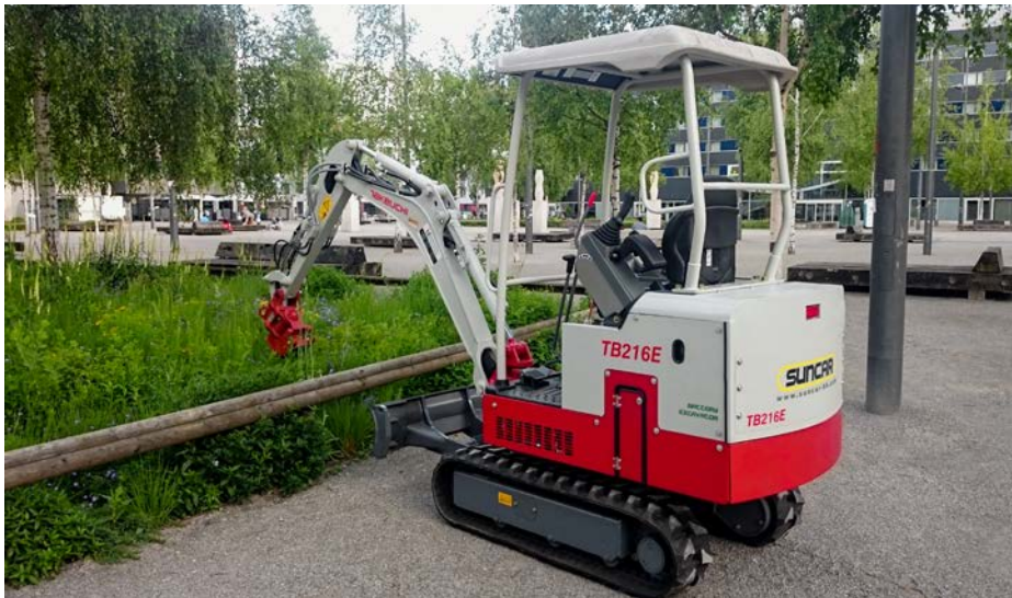
Kein Mikrobagger, aber ein Bagger mit Mikro-Emissionen ist dieser von Suncar HK auf Elektroantrieb umgerüstete TB216E.
