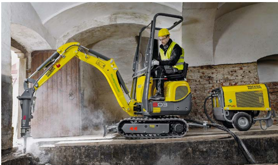
In der Version Dual Power wird der Wacker Neuson 803 von einer elektrischen Hydraulik-Kraftstation abgasfrei angetrieben.
