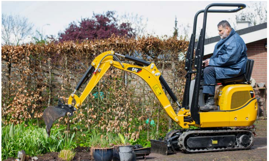
Guter Standard wie beim Caterpillar 300.9D (935 kg, 9,6 kW) sind geschätzt. Auf der Oberseite der Auslegerglieder sind die Hydraulikzylinder angeordnet.
