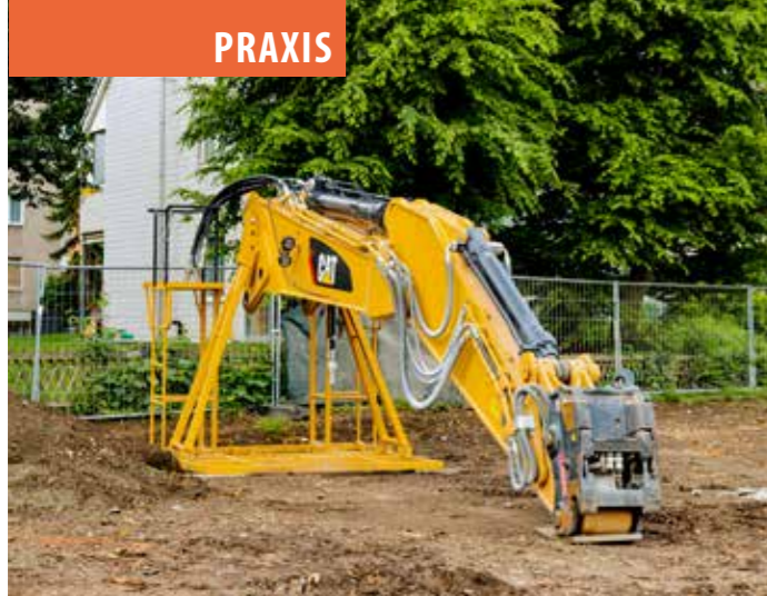
Für eine sichere Ablage und den gefahrenfreien, schnellen Wechsel der zwei Ausleger wurde von Avesco ein spezielles Transportgestell gefertigt.
