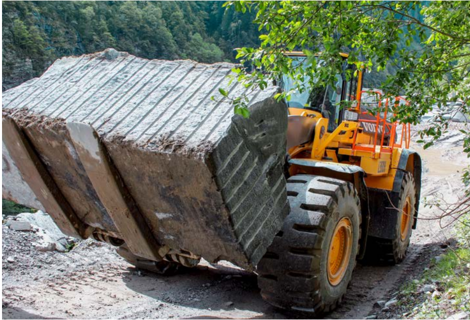
Enorme Blöcke des Gneisgesteins mit einem Gewicht von bis zu 40 Tonnen kann der Volvo-Radlader L350H mit der Steinblockgabel transportieren.
