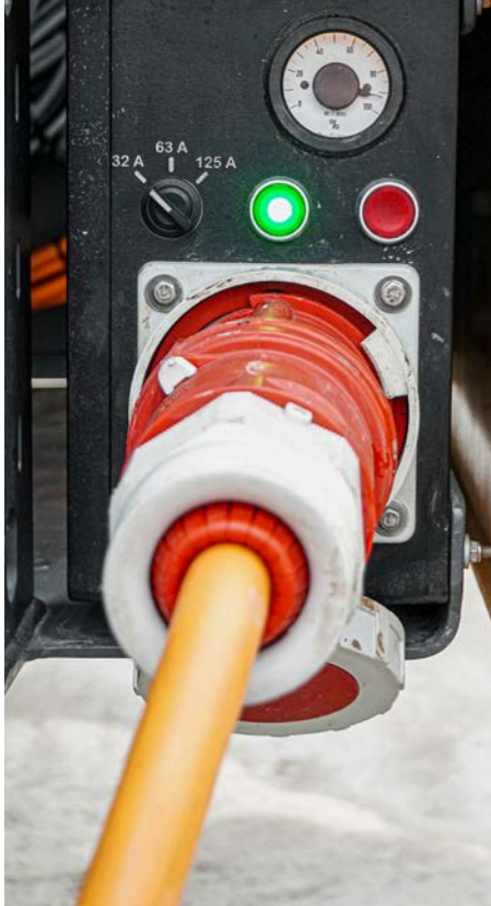
Der Akku lässt sich bequem via herkömmlicher Baustellenanschlüsse über Nacht aufladen.
