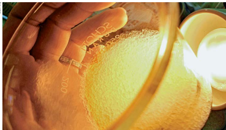
Aerogel, hier in Granulatform, besteht aus bis zu 98 Prozent Luft und dämmt deshalb sehr effizient.
