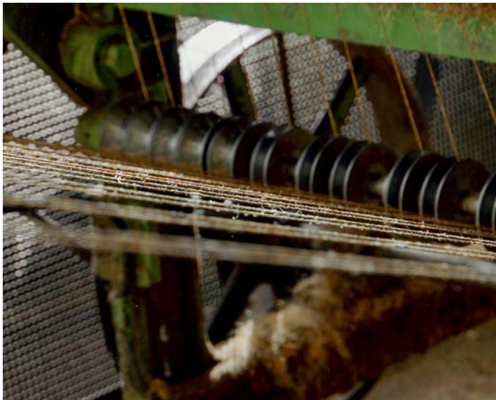
Durch mehrfaches Verziehen und Kämmen wird die Faser gestreckt.
