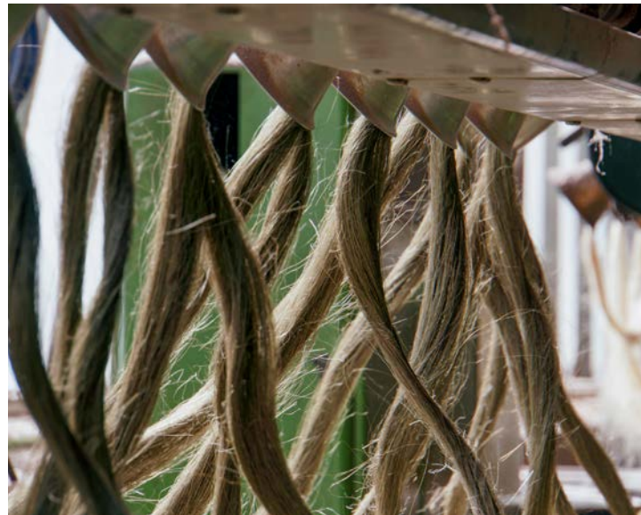
Um den Sisal geschmeidiger zu machen, wird er durch Walzen geführt.
