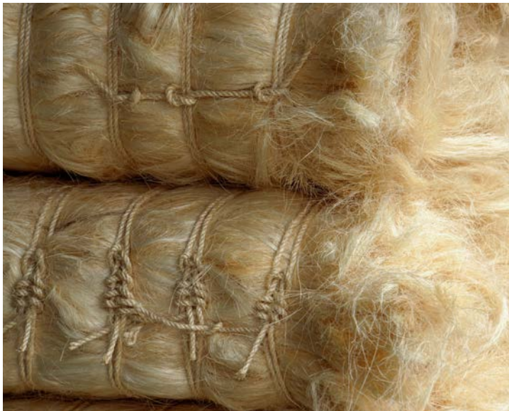
Nach der Sortierung wird der Sisal gebündelt und dann in Ballen gepresst.
