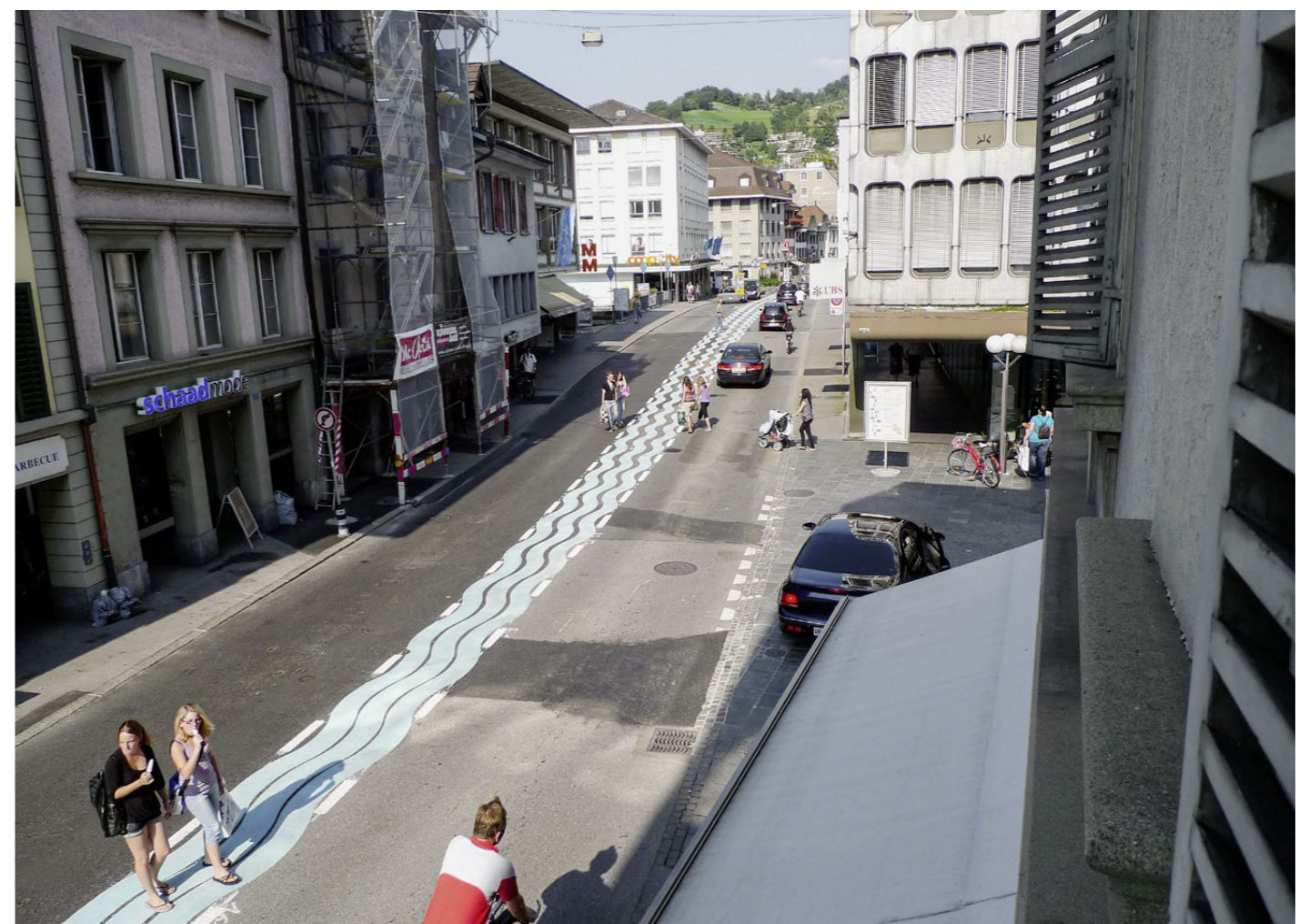
Die Thuner Lösung: Die «blaue Welle» als Querungshilfe für den Langsamverkehr zieht sich auf 160 Metern durch die Innenstadt. Als Ausgleich wurden die Fussgängerstreifen entfernt. Die Anhaltebereitschaft der Autofahrer ist sehr gross und Verkehrsstockungen durch querende Fussgängergruppen wurden markant seltener.
