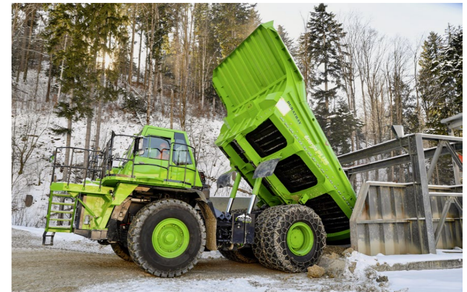
Ein riesiger elektrischer Muldenkipper des Typs Komatsu HD 605-7, umgebaut von der Kuhn-Tochterfirma «eMining», arbeitet zu 96 Prozent energieautark im Steinbruch Péry BE von Ciments Vigier.
