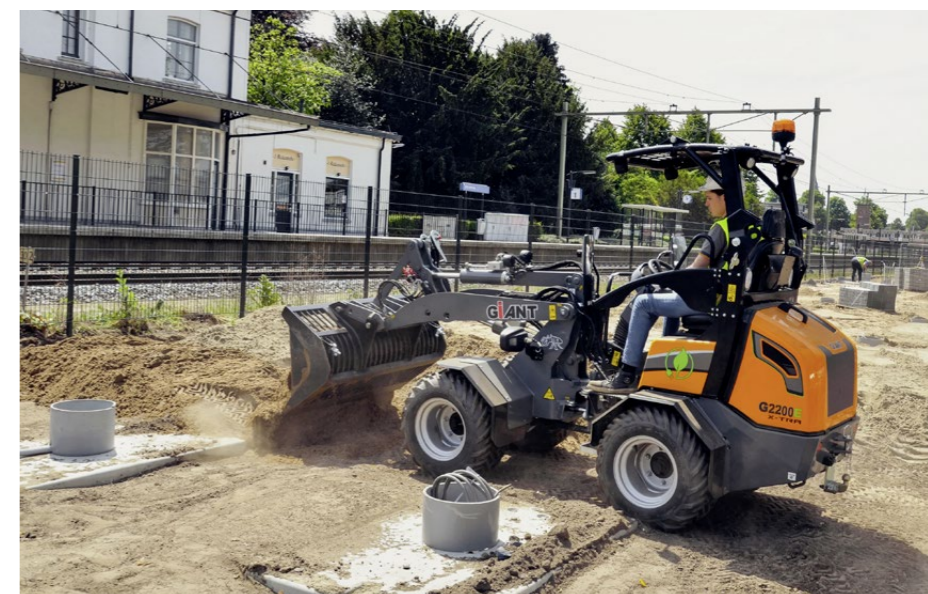
Vom niederländischen Hersteller Tobroco-Giant stammt dieser Kompaktradlader G2200E X-tra. Auf dem Schweizer Markt wird er bei den Distributoren Leiser, Aggeler und Frei erhältlich sein.
