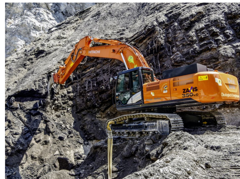
Dank seines sparsamen, wartungsarmen Elektromotors (Bild rechts) läuft im Rohstoffbetrieb des Betonherstellers Deisl-Beton ein elektrischer Grossbagger gewissermassen doppelt in der Gewinnzone.
