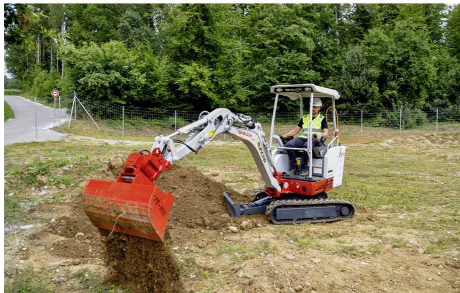
Der Minibagger TB216E ist eines von drei Takeuchi-Modellen, welche Suncar HK, eine Tochterfirma des Takeuchi-Händlers Huppenkothen, bisher auf Elektroantrieb umgerüstet hat.
