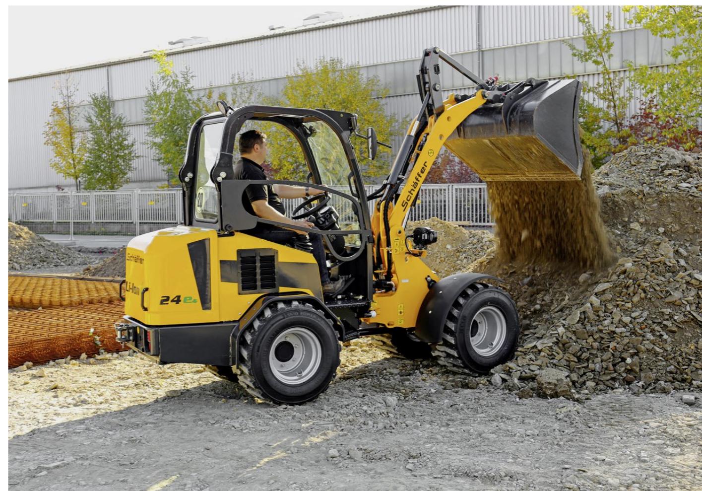
Gerade bei den häufig nur kurzzeitig eingesetzten Kompaktmaschinen wie diesem Radlader des Typs Schaeffler 24e lässt sich der tägliche Energiebedarf bequem mit einer Akkuladung abdecken.
