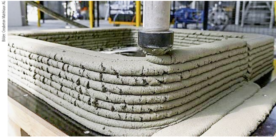
Der Swisscom-Schacht der Creabéton Matériaux AG entsteht im 3D-Beton-Drucker.
