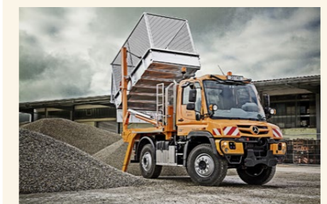
Auch bei Geräteträgern wie dem Unimog lassen sich mit Wechselaufbauten – hier ein Absetzsystem von Jotha – die Einsatzvielfalt und Auslastung erhöhen.
