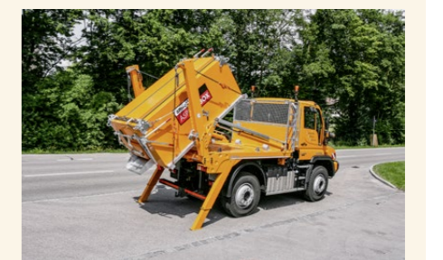
Auch bei Geräteträgern wie dem Unimog lassen sich mit Wechselaufbauten – hier ein Absetzsystem von Jotha – die Einsatzvielfalt und Auslastung erhöhen.
