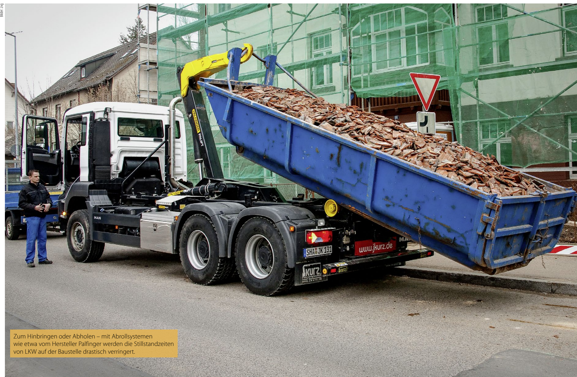
Für Baumaschinen oder Pflanzenkübel – der Hersteller Maytec bringt mit Abrollsystemen auch kleinen Betrieben neuen Schwung in ihre Baustellenlogistik.
