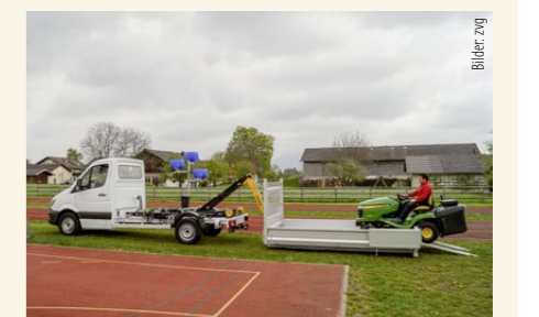
Mit dem kleinen Abrollkipper City kommt der Hersteller Palfinger den Besitzern von Pkw-Führerausweisen entgegen. Er bietet 1000 Kilo Nutzlast.
