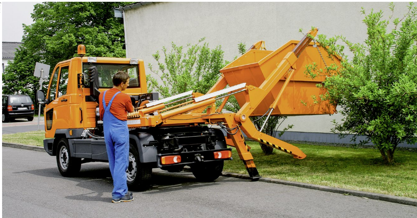
Der vielseitige Multicar Fumo kann mit einem Absetzkipperaufbau von Meier-Ratio seine Nutzlast in nahezu alle Richtungen absetzen – auch seitwärts.
