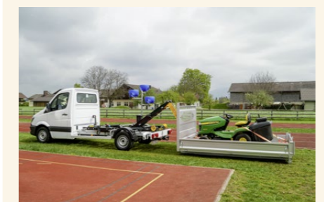
Mit dem kleinen Abrollkipper City kommt der Hersteller Palfinger den Besitzern von Pkw-Führerausweisen entgegen. Er bietet 1000 Kilo Nutzlast.
