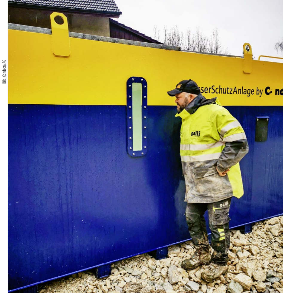
Adrian Meyer von der Firma Galli Hoch- und Tiefbau, Zuchwil, kontrolliert durch das Sichtfenster den Stand der abgesetzten Feststoffe in der Gewässerschutzanlage.
