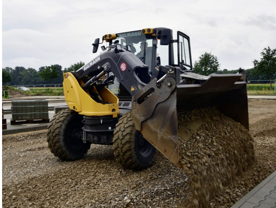
Der AS900 gehört mit einer Schaufelgröße von 0,9 Kubikmetern ins Mittelfeld der weltweit wohl einzigartigsten Mecalac-Schwenklader mit ungeteiltem Fahrzeugrahmen und Allradlenkung.
