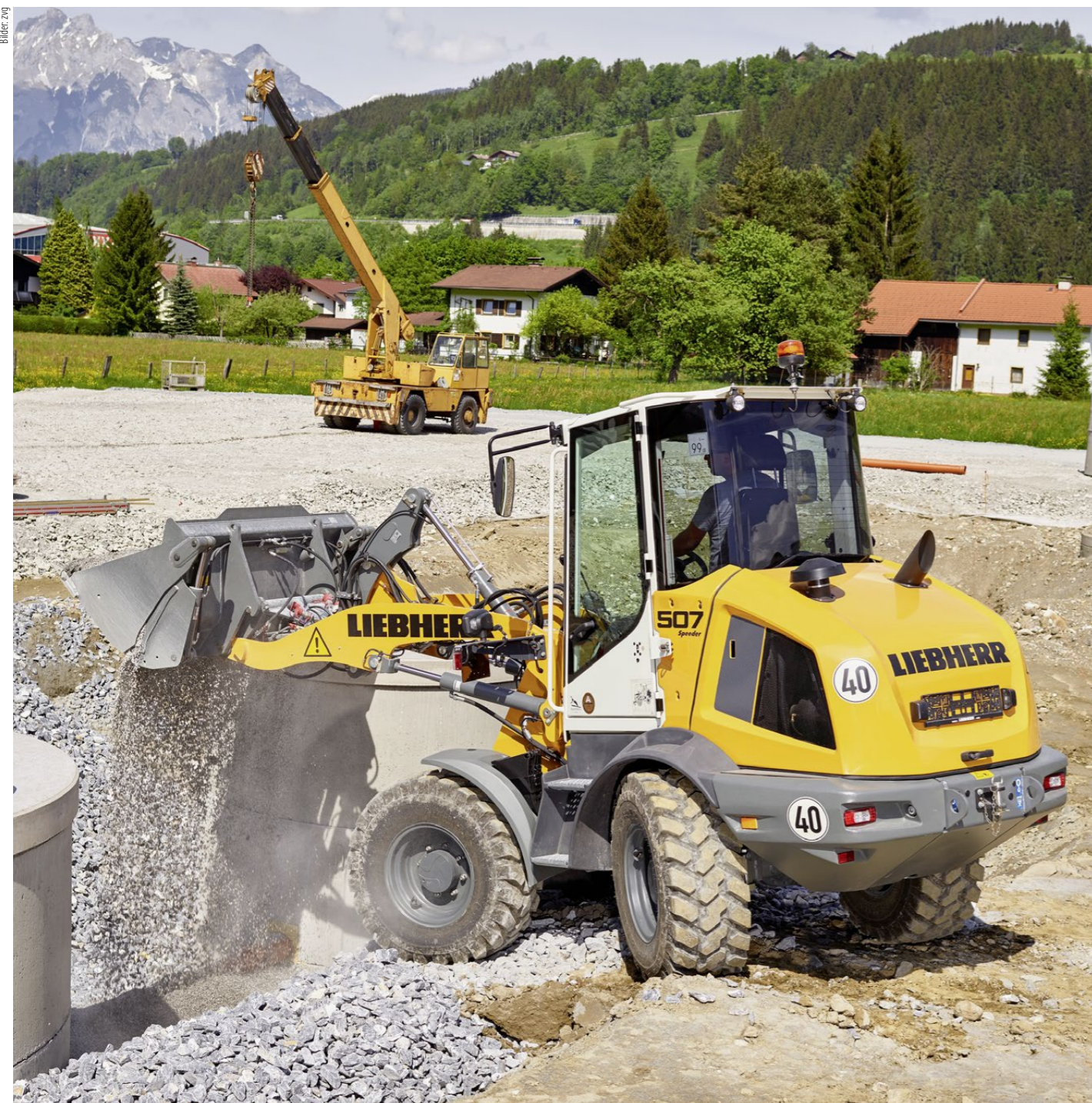
Der L507, einer der kompakten Stereolader von Liebherr: Seine Wendigkeit verdankt er einer kombinierten Knick- und Hinterachslenkung.
