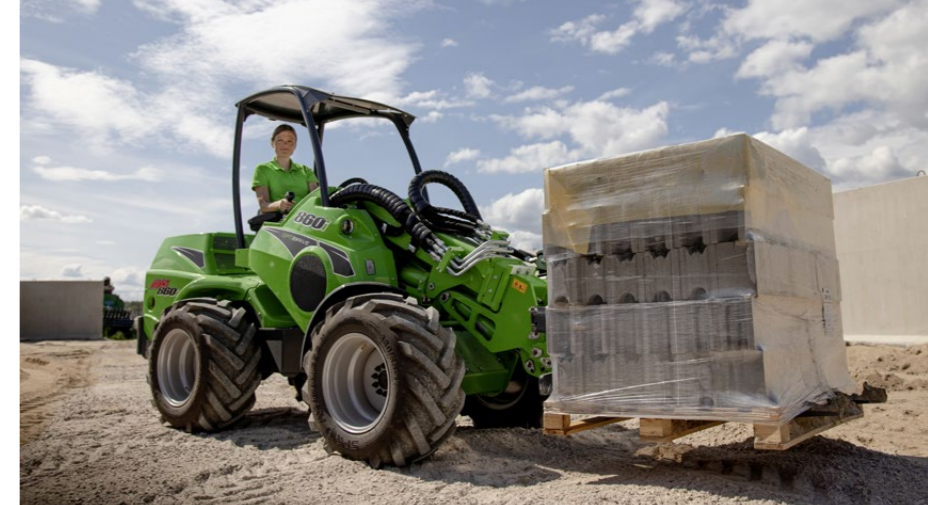
Genügend Hubkraft für eine schwere Steinpalette, aber 2540 Kilogramm leicht: Der Avant 860i holt Bärenkräfte aus seinem knappen Kleid.
