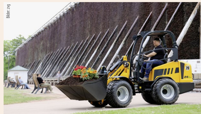
In der grünen Branche beliebt: Erfreuliche Verkaufszahlen meldet Schäffer für seinen kompakten, aber kräftigen 24e, der Energie aus einem Lithium-Ionen-Akku bezieht.
