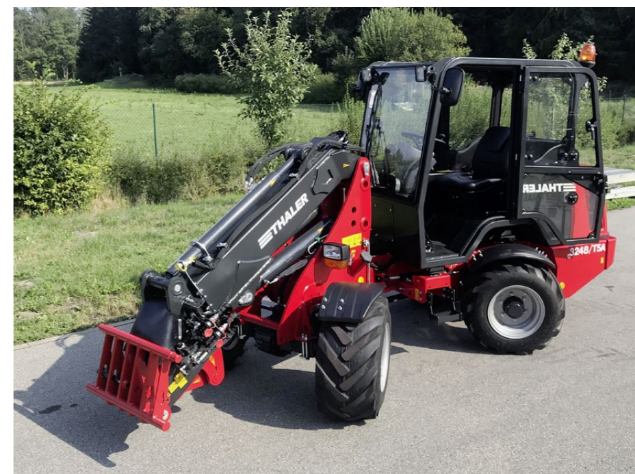
Thaler hat mit seinem «Fünffachs-Lenker» einen Radlader mit den Vorteilen einer kombinierten Knick- und Achslenkung herausgebracht.
