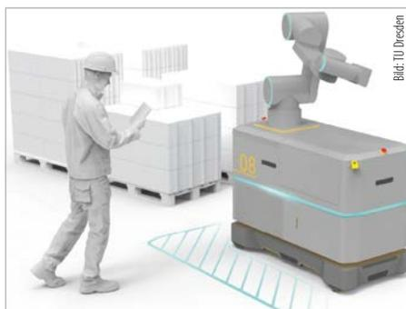
Ein Feature des Wallbot ist die Sicherheit: Hält sich ein Mensch zu nahe im Gefahrenbereich bei der Maschine auf, wird die Arbeit gestoppt.
