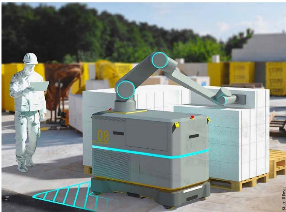
Der Wallbot der TU Dresden besteht nicht nur aus einem Maurerroboter, sondern aus einem System von Maschinen, die komplett autark arbeiten können.
