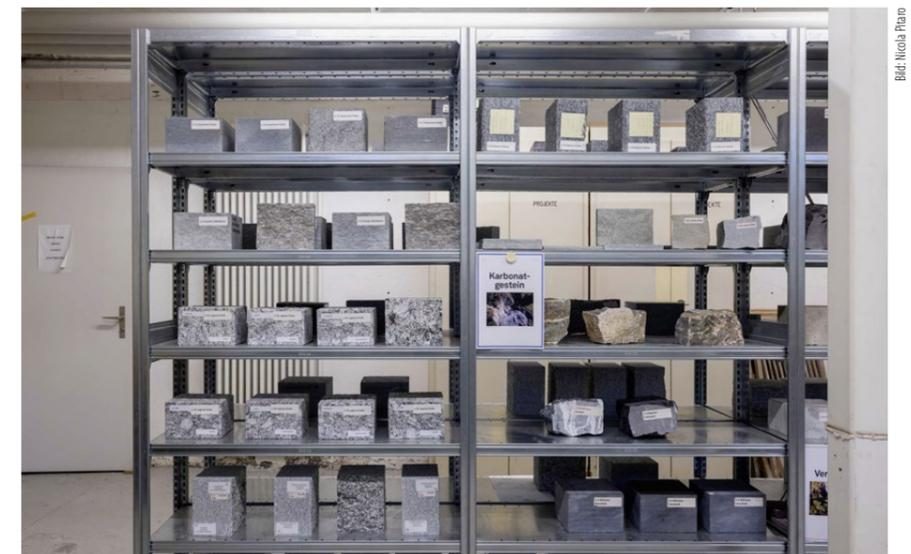
Der Natursteinkeller: Hier werden die Steinsorten dokumentiert, die an Kunstbauten der Rhätischen Bahn verwendet worden sind, insbesondere ist dort deren Verwendungsort erfasst. Er dient als Planungserleichterung sowohl für Neubauten als auch für Instandsetzungen.
