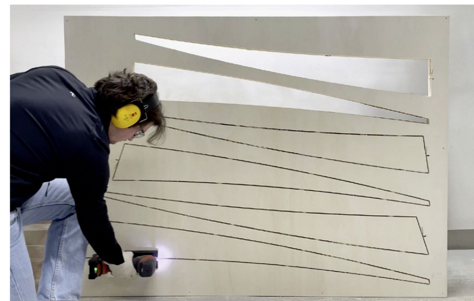
Einfache Fertigung: Aus der Sperrholzplatte werden einzelne gekrümmte Streifen ausgeschnitten.
