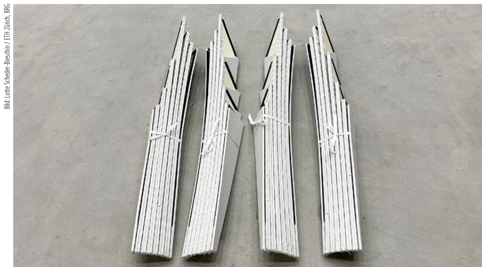
Die vier gefalteten Schalungsteile sind bereit für den Einsatz.
