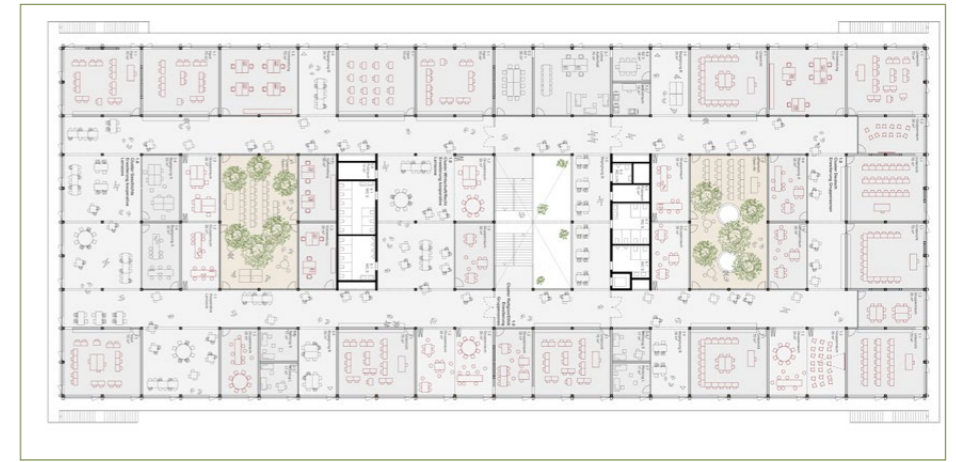
Die dreibündige Erschliessung im Obergeschoss lässt sich mit Verbindungen der Korridore an den Längsenden in einen Erschliessungsring verwandeln.
