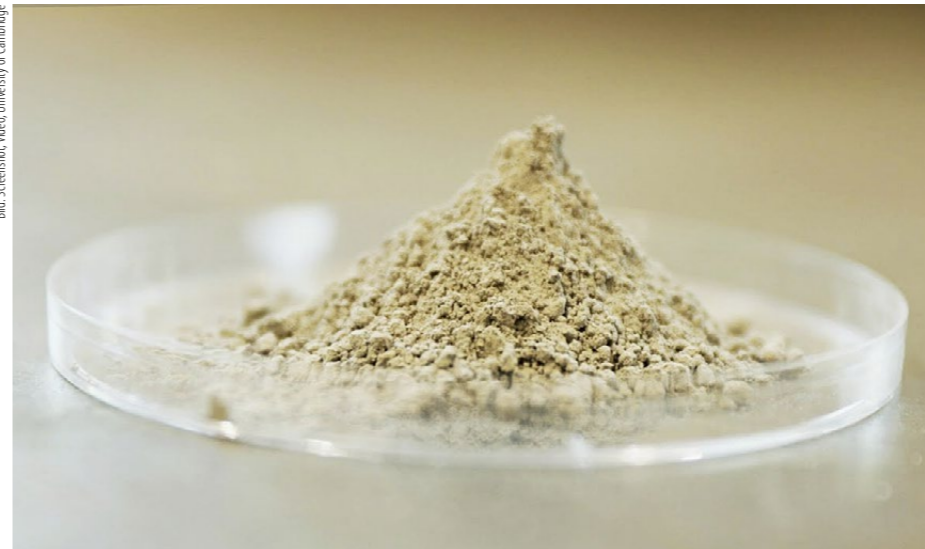
Der Beton wird so stark zerkleinert, dass sich der alte Zement vom Sand und den Steinen trennt und sich daraus eine Art Pulver ergibt. Die Forscher nennen das Material «Cement Paste».
