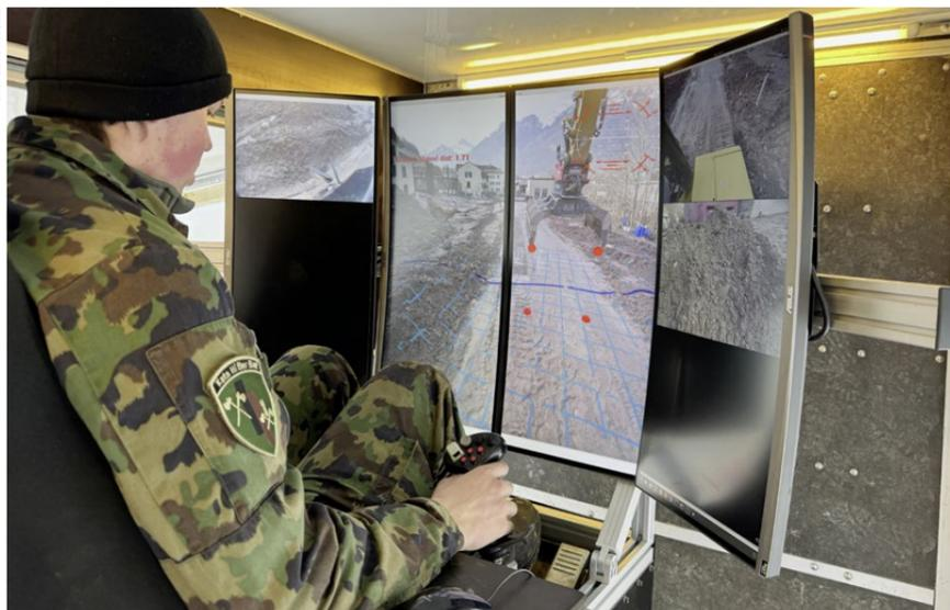
Alles im Blick: Der Baggerführer sitzt in sicherer Entfernung zum Einsatzort, kann die Maschine aber trotzdem präzise steuern.
