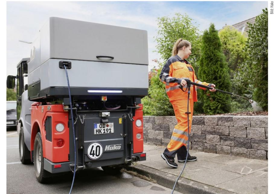
Der «Hako Citymaster 1650» mit einem Mehrzweckaufbau von Weeco zum Hochdruckreinigen, Bewässern von Pflanzen und zur Wildkrautbekämpfung.
