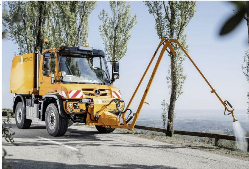
Eco Technologies rüstet Kommunal-Geräteträger sowie Kompakt- und Schmalspurtraktoren mit präzise steuerbaren Giessanlagen aus.
