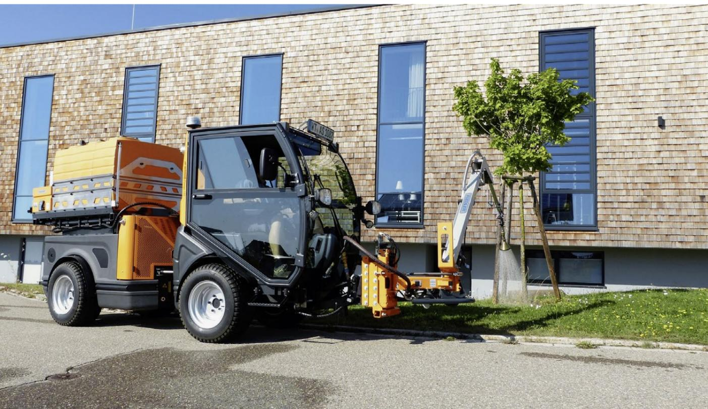
Der kompakte, knickgelenkte Geräteträger «Flexigo 150» von Aebi Schmidt, hier mit einem Giessarm vom deutschen Hersteller Fiedler.
