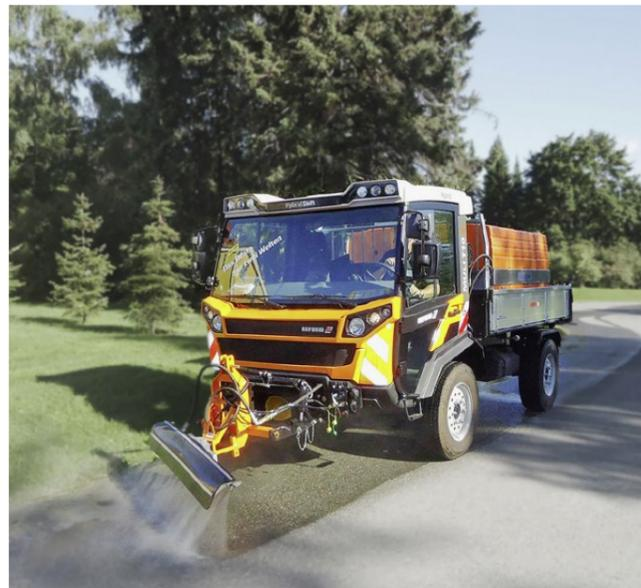
Einen leistungsfähigen Langstreckenläufer bieten die Reform-Werke mit dem «Muli T10X HybridShift», hier bei einem Einsatz mit dem Schwemmbalken.
