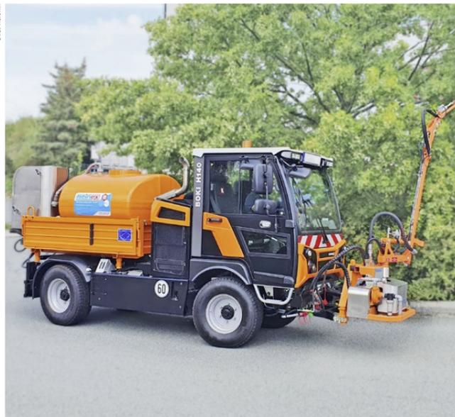
Der Kommunal-Geräteträger «Boki H140» von den Reform-Werken mit einer Kombi-Anlage von Reinex – hier mit dem beweglichen Frontanbau-Giessarm.
