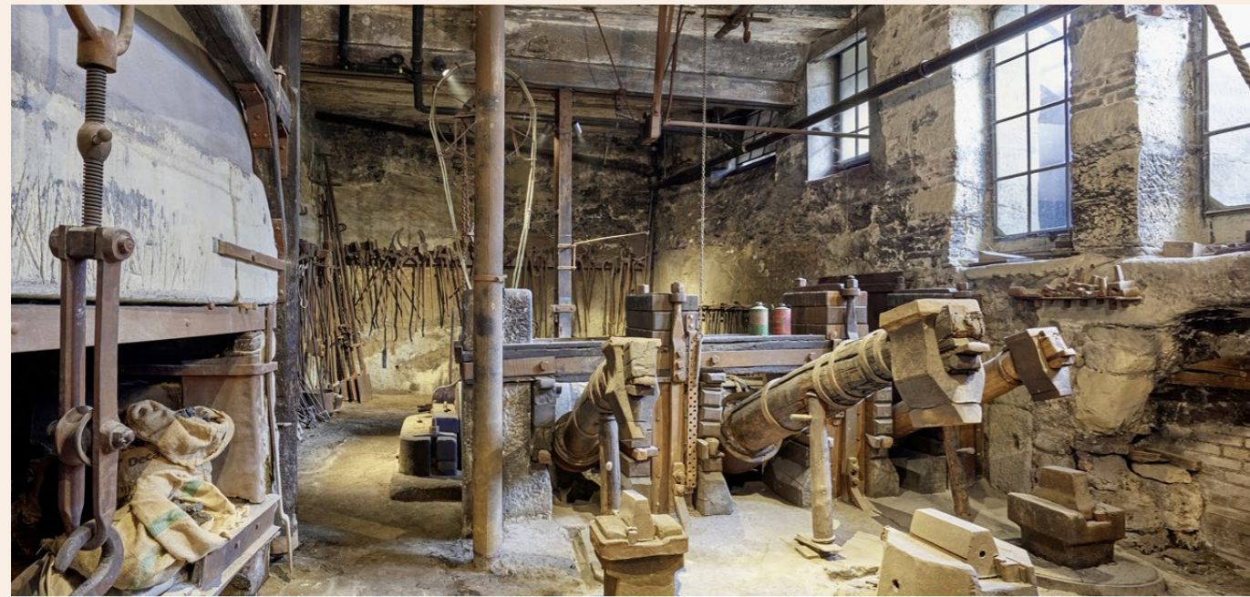
Eine industriegeschichtliche Rarität: Die Hammeranlage mit eichenem Wellbaum und drei wassergetriebenen Schwanzhämmern aus dem 19. Jahrhundert im ältesten Teil der Hammerschmiede Worblaufen.
