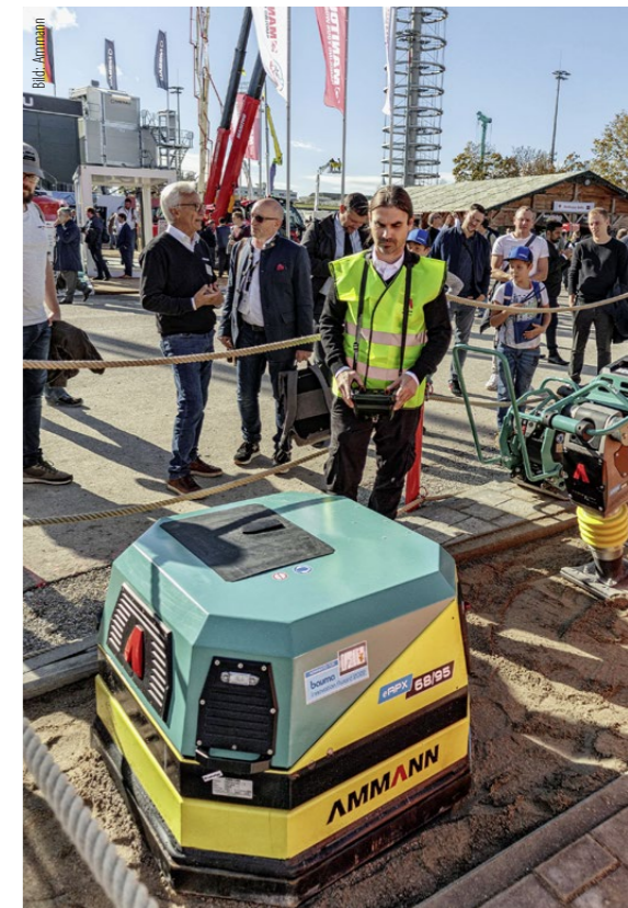
Eine ungewöhnliche Bauform hat der ferngesteuerte, elektrische «eAPX 68/95» (3D-Compactor) von Ammann. Dank vier Erregerinheiten kann dieser in alle Richtungen fahren.
