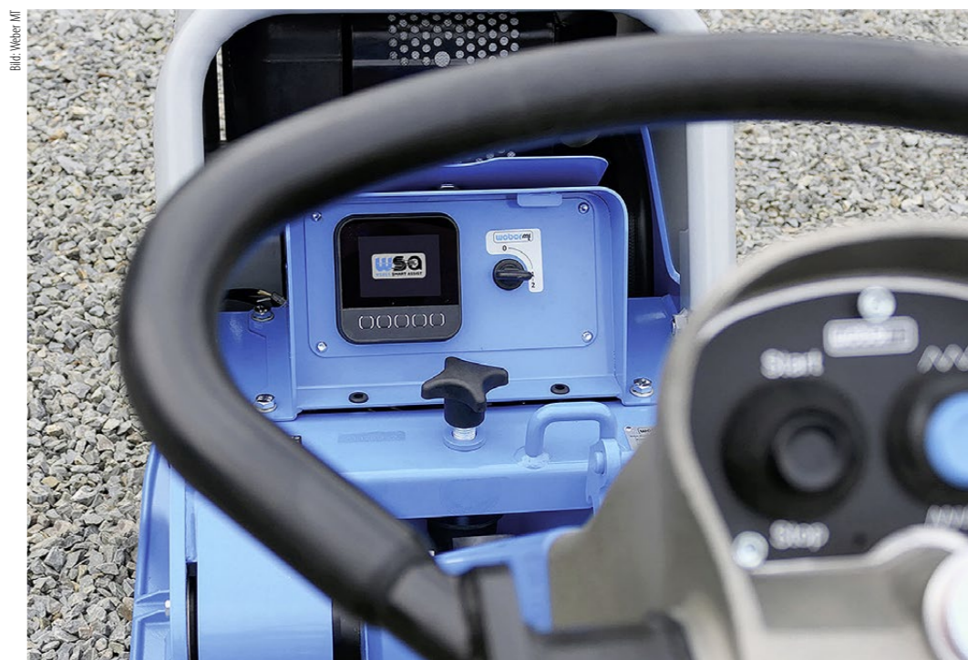
Moderne Hersteller verfeinern ihre leichten Verdichter mit der Möglichkeit, den Verdichtungsgrad des bearbeitenden Materials anzuzeigen. Bei Weber MT heisst die Systematik «Smart Assist».
