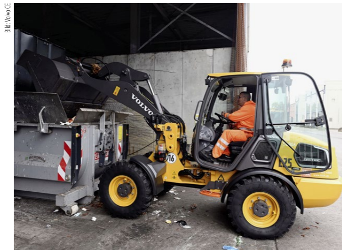
Ein Kompaktraddler Volvo L25 im Dienst der Berliner Stadtreinigung (BSR). Unter anderem befüllt er einen Presscontainer mit Abfällen aus öffentlichen Müllkörben.
