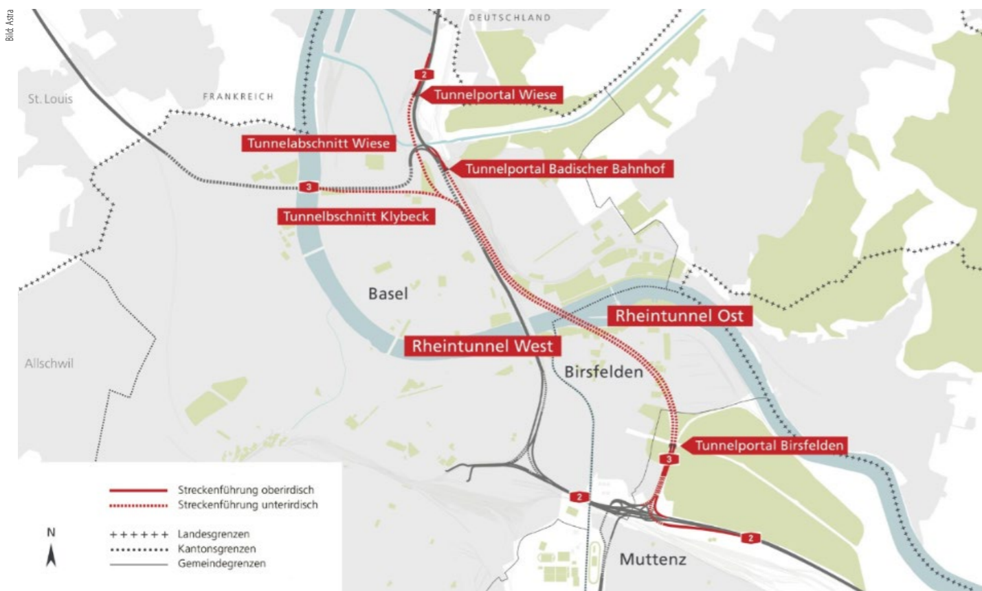
Der Rheintunnel wird das untergeordnete Strassennetz der Agglomeration Basel entlasten.
