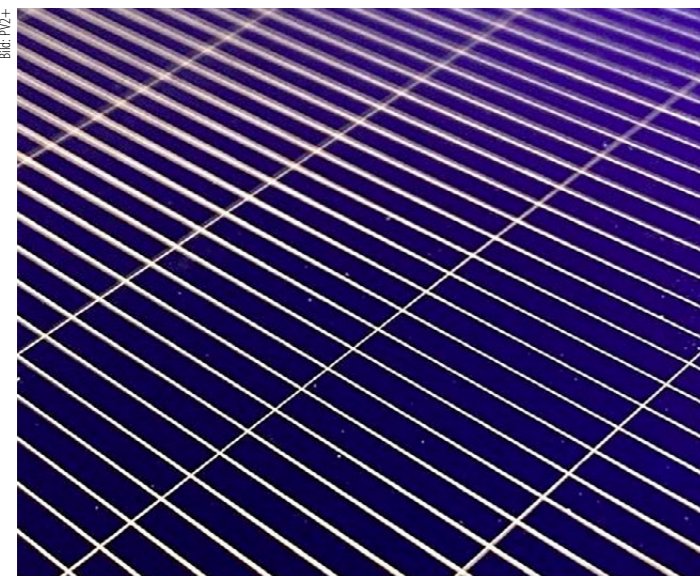
Die Leiterbahnen aus Kupfer sind mit 19 Mikrometer extrem dünn. Deshalb ist auch die Verschattung der lichtempfindlichen Siliziumschicht sehr gering.
