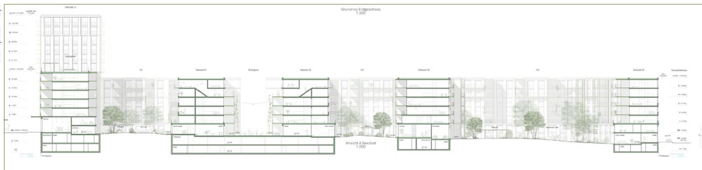
Unter der als urbane Promenade ausgestalteten Stadtgasse befindet sich die zweigeschossige Einstellhalle.
