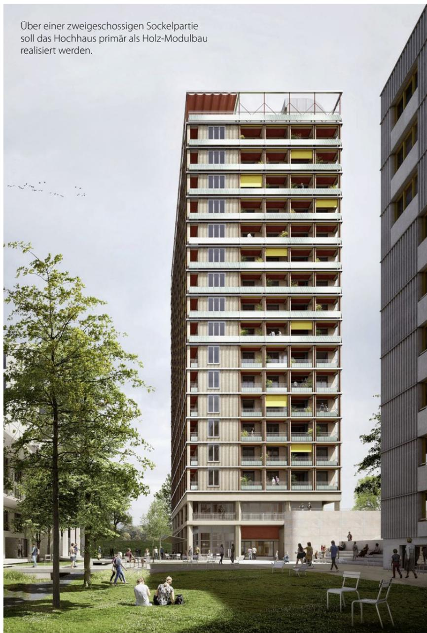
Über einer zweigeschossigen Sockelpartie soll das Hochhaus primär als Holz-Modulbau realisiert werden.
