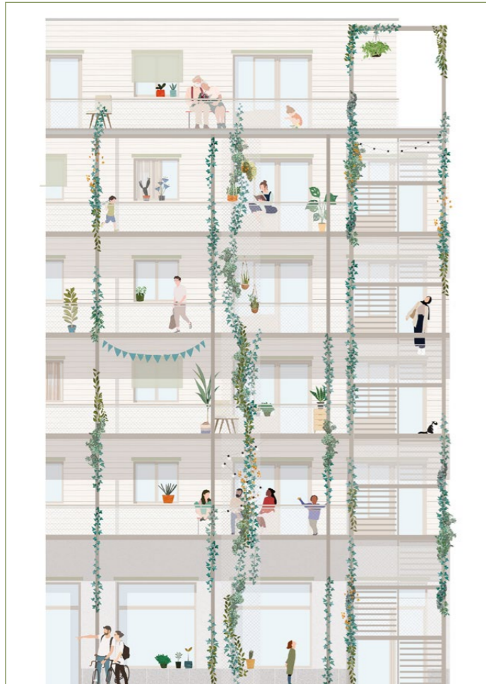
Die Laubengänge am Hof sind als Gemeinschaftsterrasse ausgebildet. Sie sollen aus wiederverwendeten Metallteilen erstellt werden.
