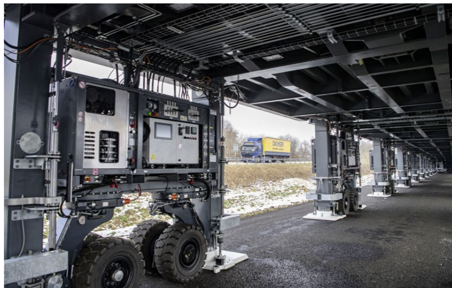
Unter der Astra Bridge: Jedes Segment hat einen eigenen Radsatz mit Power Unit, sodass der Tatzelwurm nach Arbeitsende an den neuen Einsatzort vorgefahren werden kann; alles über GPS gesteuert.
