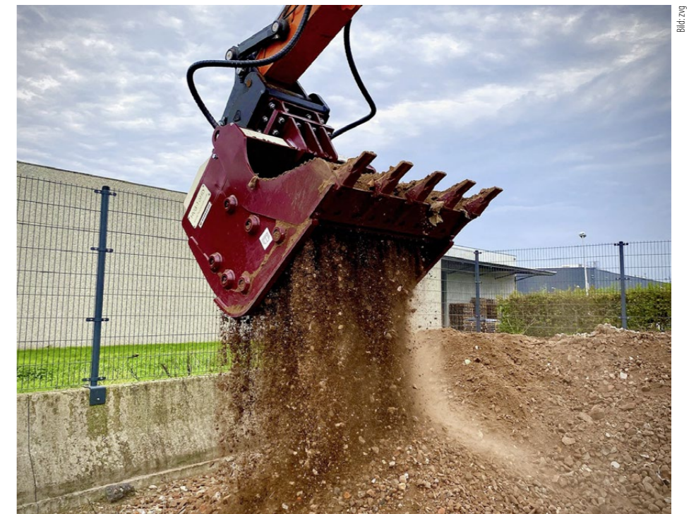
Dieser Anbauseparator von Hydraram passt an Bagger von 13 bis 20 t Einsatzgewicht. Der Hersteller hat auch deutlich kleinere Grössen für Gärtner.
