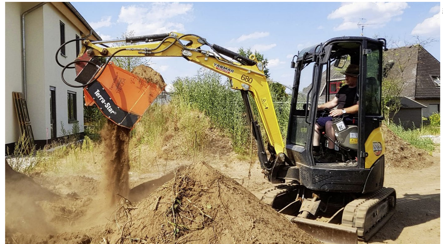
Die TerraStar-Modelle von Kronenberger Oecotec sind schon an kleinen Geräteträgern hoch wirksame Anbauseparierer für verschiedene Materialien.
