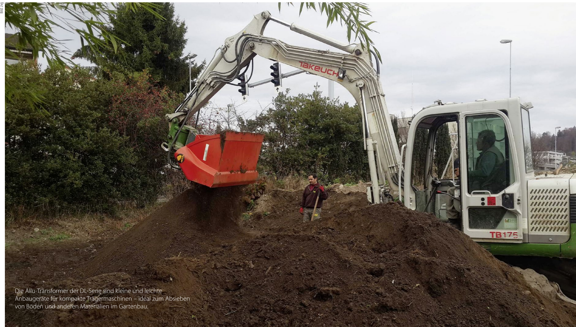
Die Rotastar-Sieblöffel des britischen Herstellers Lloyd (Hydremag) sind bereits in kompakten Abmessungen für Bagger ab 2,5 t zu haben.
