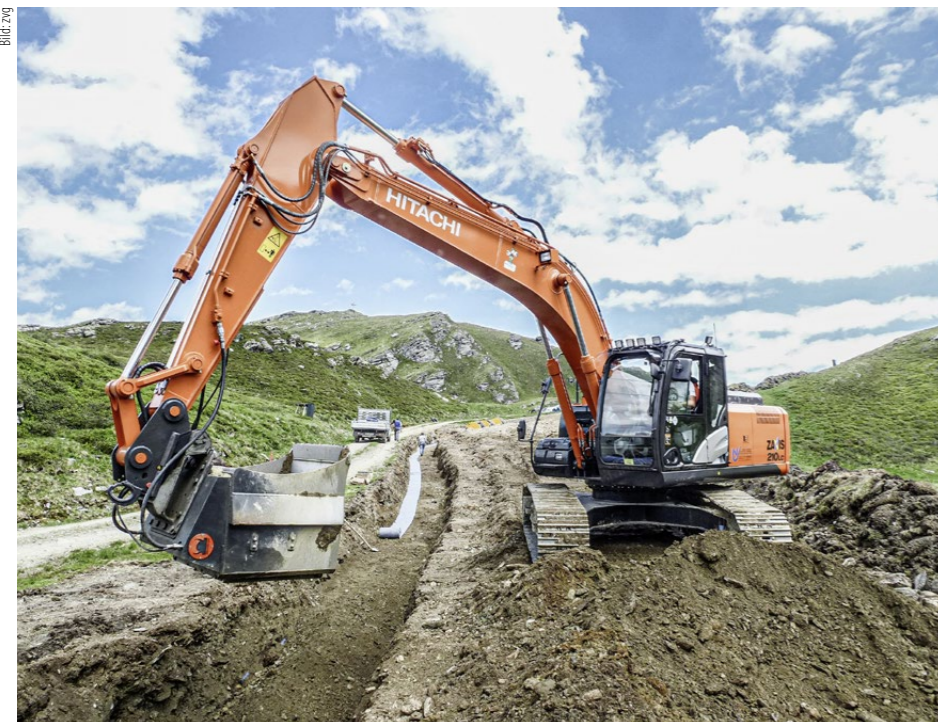
Für Trägergeräte ab 3 t eignen sich die Schaufelseparatoren von Skancraft. Zur Herstellung von Flüssigboden bietet der Hersteller optional ein Dosiergerät.
