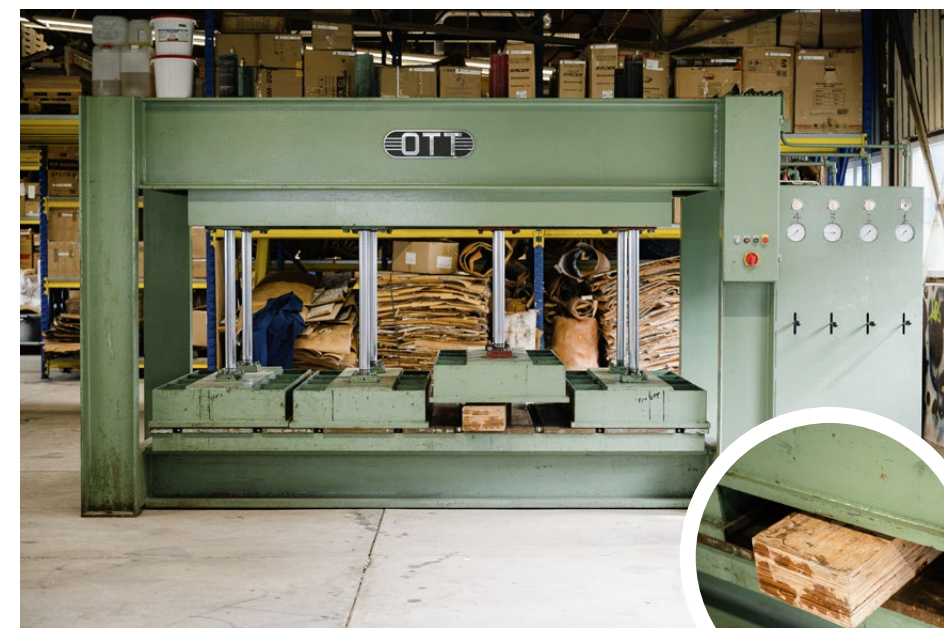
Die Ott-Furnierpresse verpresst die einzelnen gestapelten Birkenrindenschichten mit dem Klebesystem zum Furnierblock.
