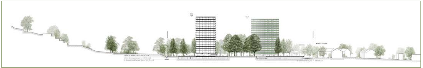
Der Schnitt von Ost nach West zeigt, dass das Areal nahezu eben ist. Am rechten Rand ist der vorgeschlagene Hallenbau zu erkennen.
