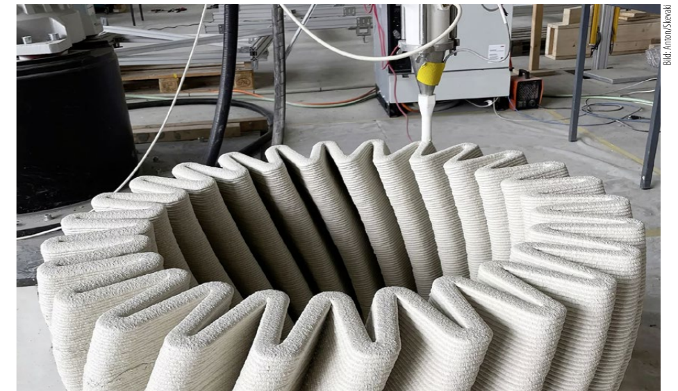
Der Prototyp einer Säule wird in der ETH auf dem Höggerberg ausgedruckt. Die effektiv verwendeten Bauteile sollen in Mulegns in einer Feldfabrik ausgedruckt werden.
