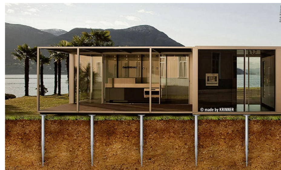
Der Einsatz von stählerne Fundamenten verspricht völlig neuartige Kosten-Nutzen-Relationen auch im Hallen und Containerbau.
