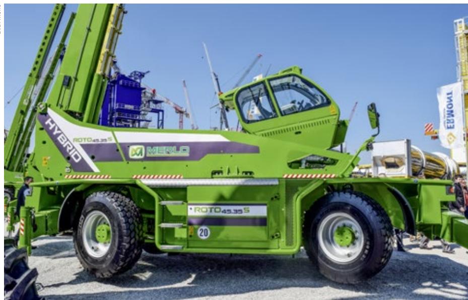
Bei längeren Stationäreinsätzen, ob mit Hubbühne, Kran oder anderen Ausrüstungen, kann der Teleskopstapler Roto 45.35 von Merlo dank Hybridantrieb mit 400-Volt-Kabelzuführung abgasfrei und leise elektrisch arbeiten.
