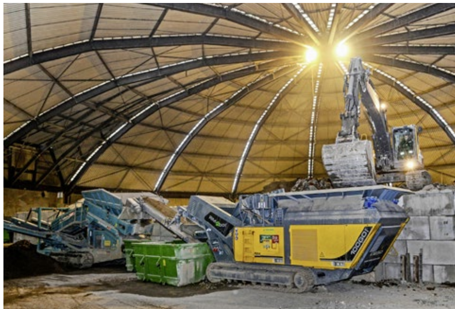
Der Prallbrecher «RM 100 Two-GO!» von Rubble Master arbeitet je nach Einsatzart wahlweise mit Dieselmotor oder Elektroantrieb über externe Einspeisung wie hier durch eine Solaranlage auf dem Hallendach.
