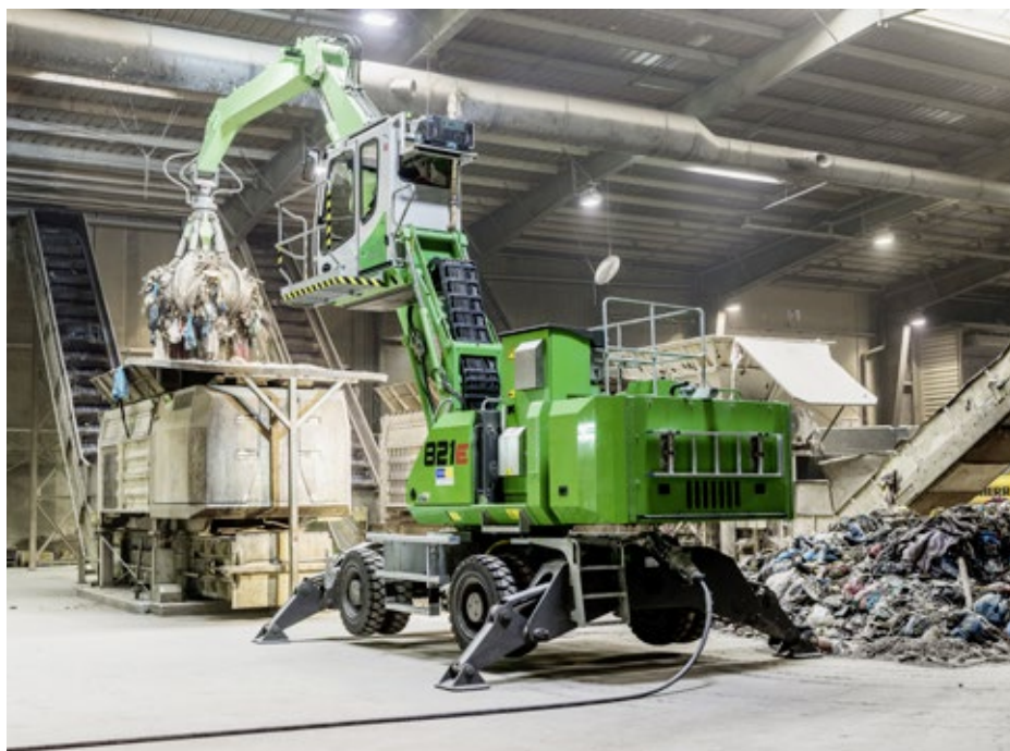
Mobilität und Flexibilität vereint dieser Umschlagbagger 821E Elektro von Sennebogen: Bei stromlosem Dieseltreibetrieb versorgt ein im Heckballast integriertes Power-Pack den Bagger jederzeit mit genügend Energie.
