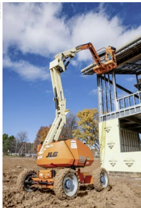
Sowohl rein elektrisch als auch im Dieselbetrieb kann die allradgetriebene H340AJ von JLG arbeiten, die weltweit erste Hybrid-Teleskoparbeitsbühne. Acht Bordbatterien werden im Dieselbetrieb rasch aufgeladen.
