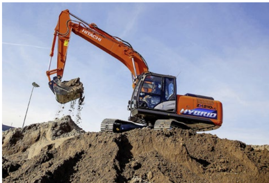
Der ZH210LC-5 Hybrid von Hitachi zeigt, dass die Rückgewinnung der Schwenkenergie besonders bei weiten Schwenkwinkeln viel Kraftstoff einspart, weil der Oberwagen ständig grosse Schwenkbeschleunigungen erfährt und sodann stark abgebremst wird.
