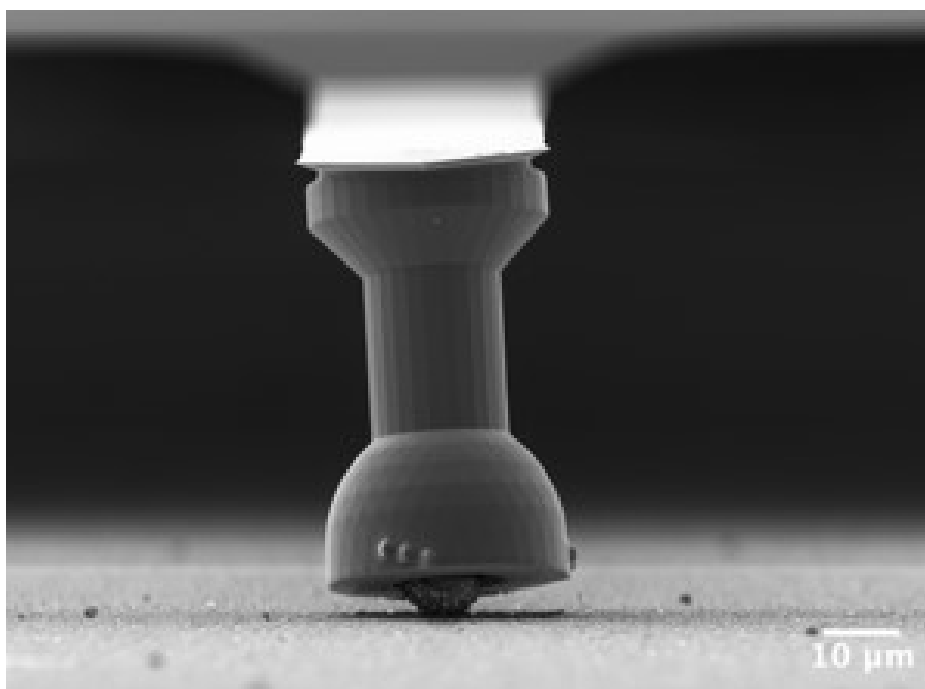
Ein rauer Partikel wird auf ein Substrat mit gleichwertigen Eigenschaften gedrückt und horizontal bewegt, um die Reibung zwischen den beiden Oberflächen zu bestimmen. Repräsentatives Bild vom Versuchsaufbau, Aufnahme mit einem Rasterelektronenmikroskop.
