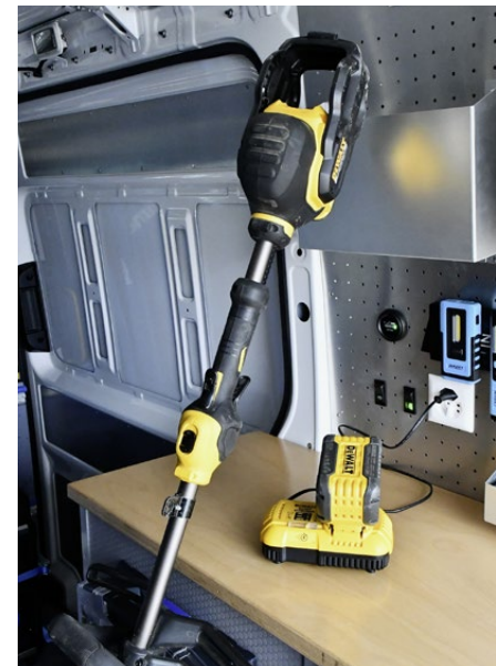
Allzeit ladebereit: Im Kastenwagen eine Ladelösung mit 230-V-Wechselrichter von Sortimo, im Freien eine mobile Ladelösung am Einsatzort.
