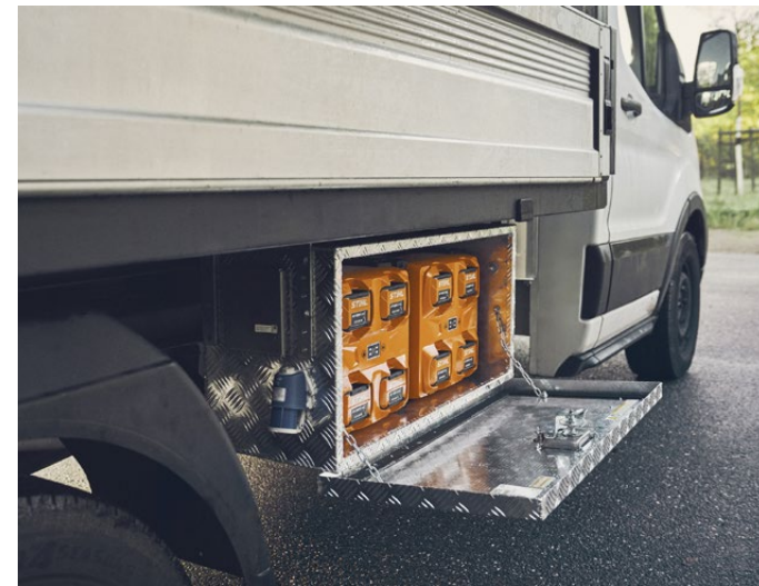
Die unter der Fahrzeugpritsche montierte Transport- und Ladebox von Stihl braucht kaum Platz und kann acht Akkus aufnehmen. Rechts: Das Fahrzeug von Innen.
