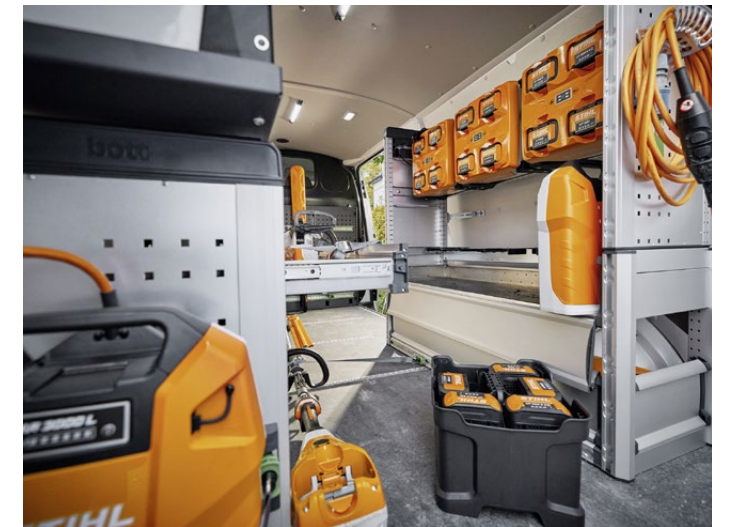
Die unter der Fahrzeugpritsche montierte Transport- und Ladebox von Stihl braucht kaum Platz und kann acht Akkus aufnehmen. Rechts: Das Fahrzeug von Innen.
