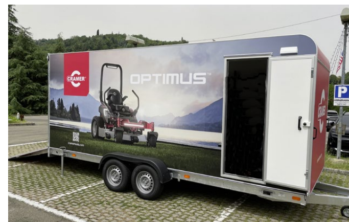
Professionelle Ladetechnik unterwegs: Cramer bietet mit seinem transportablen «EnergyCube» (16 kWh Kapazität) auch an Orten ohne Stromanschluss genügend Strom zum Aufladen zahlreicher Akkugeräte und Zero-Turn-Mäher.
