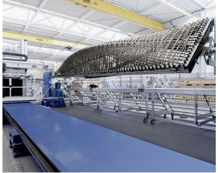
Der nächste Schritt in der Vorfertigung der Flachsfaserkomponenten mit Faserwickelmaschine, die bei einem Industriepartner erfolgte.
