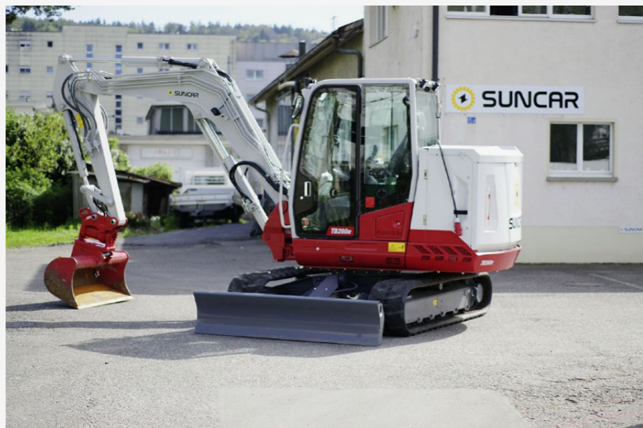
Im Auftrag des Takeuchi-Distributors Huppenkothen hat dessen Tochterfirma Suncar AG zwei kompakte Elektrobagger von 1,9 und 6 Tonnen Gewicht mit Lithium-Ionen-Batterien ausgerüstet.
