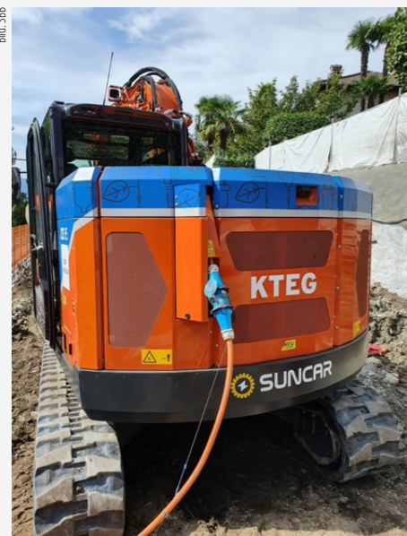
Der «ZE85» wurde über Mittag und nach Feierabend aufgeladen, was sich problemlos in die Baustellenabläufe einpassen liess.
